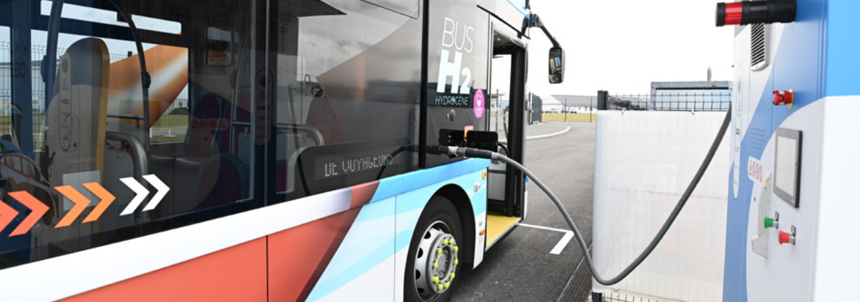
Bus hydrogène du Mans en cours d'avitaillement sur la station de l'Automobile Club de l'Ouest
